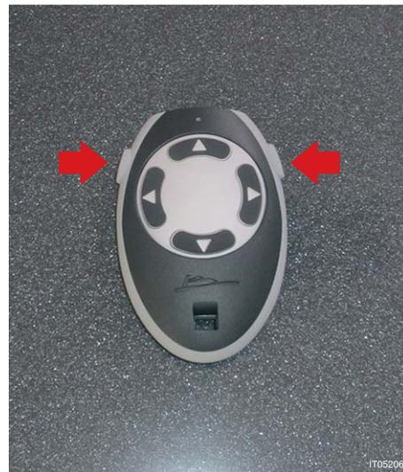
Tenendo i due tasti premuti premere il tasto relativo al movimento desiderato (si accende il led colore rosso). Quando il led lampeggia con frequenza di due secondi, sostituire la batteria. Svitare le quattro viti e rimuovere il coperchio; utilizzare solo batterie R2032 litio.
